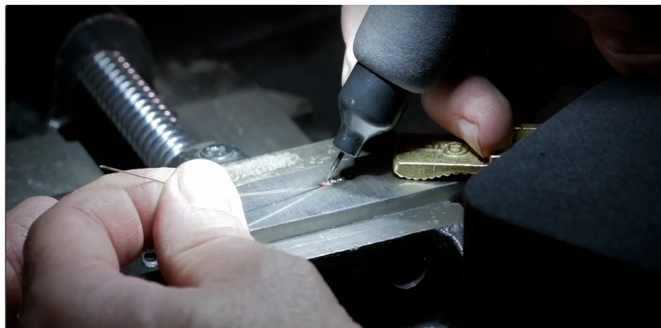
2. Detail hořáku a navařování na oceli
