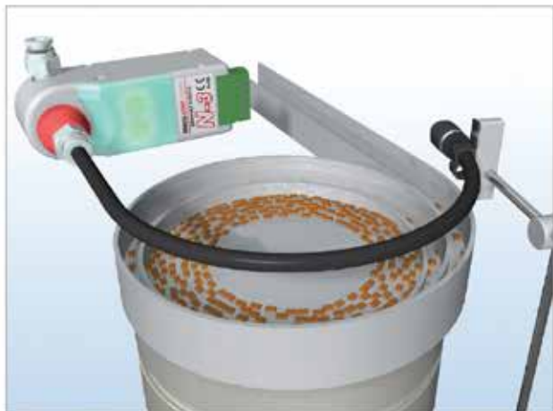
Použití na vibračním podavači s ionizátorem N-3.
