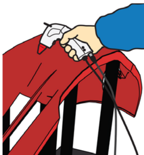
Odstraňování prachu a statické elektřiny z nárazníků.
