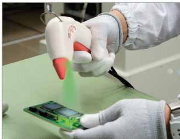
Kontrola povrchu LED diodou pomocí pistole G7R-E.
