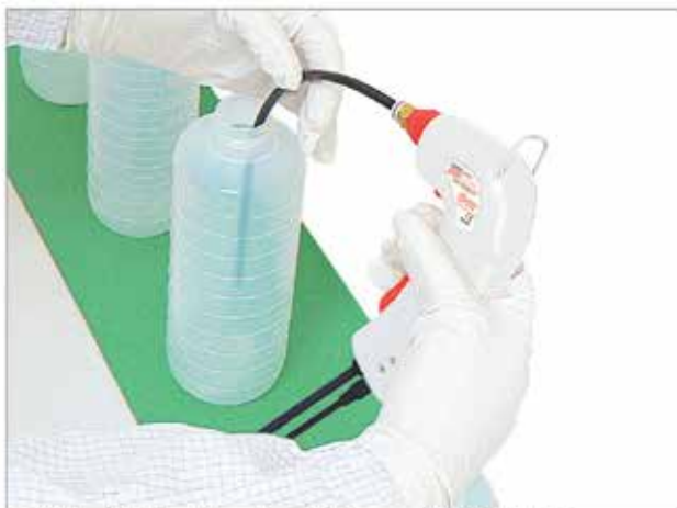
Statické odstraňování prachu v lahvi pomocí pistole G7R-E.
