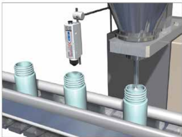
Odstranění kapaliny v plnicích linkách pomocí ionizátoru N-1.
