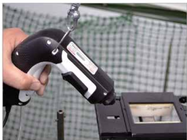
Statické odstraňování prachu na součástech pomocí pistole G2-E.
