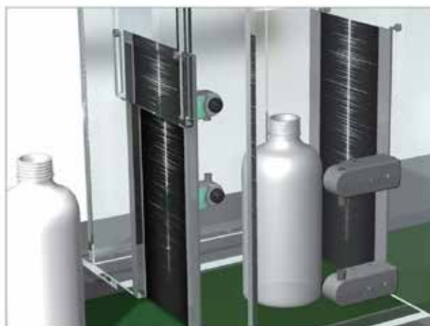
Čištění lahvi pomocí ionizátoru N-3.
